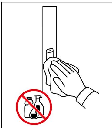
A limpeza do espelho do recolhedor comercializado pela Roto Fermax deve ser feita com um pano macio e seco, não utilizando detergentes, abrasivos, produtos de limpeza e outros agentes que possam deteriorar ou oxidar o produto.
